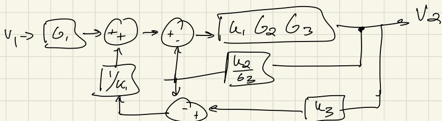
$$v_1 \rightarrow \left\{ \begin{array}{l} \boxed{u_1, G_1, G_2, G_3} \\ 1 + G_1 G_2 G_3 + G_2 G_3 - G_2 G_3 u_3 \end{array} \right\} \rightarrow v_2$$
